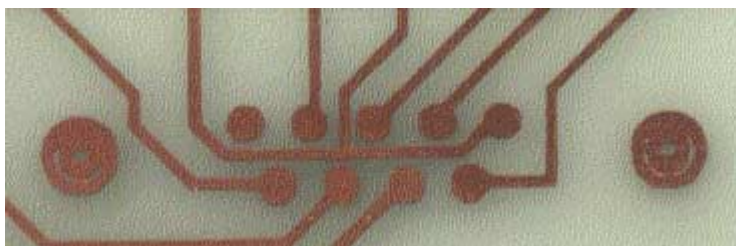
Obr.11 detail PCB pro DB-9, kresleno Staedtler 0,5 mm
